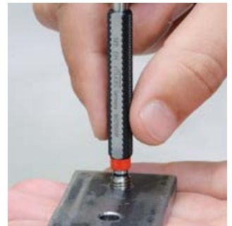
Prüfung mit Präzisions-Gewindelehrring Checking with Precision Thread Plug Gauge
